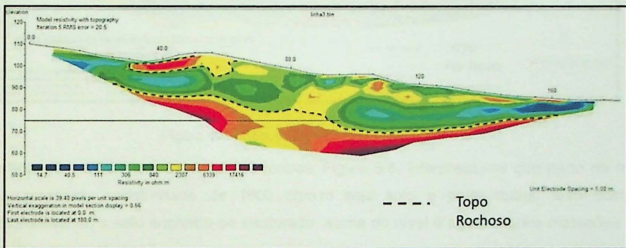
Figura 6.5 - Seções L3 longitudinais ao eixo do túnel.
